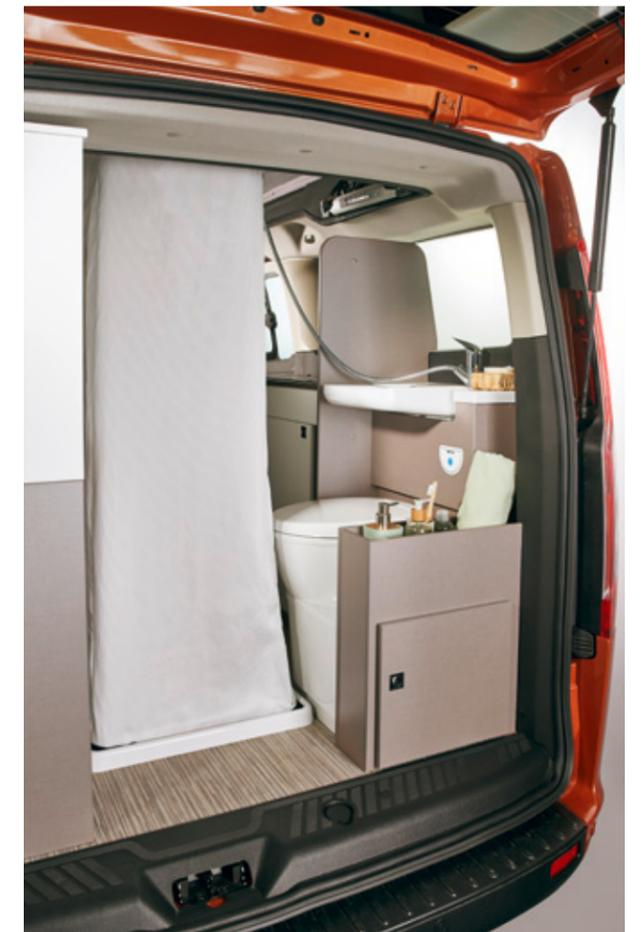
Ein Bad mit Klappwaschbecken, fest verbauter Kassetten-Toilette, einer steckbaren Duschwanne mit Duschvorhang sowie einem herausziehbaren Wasserhahn als Duschkopf.
