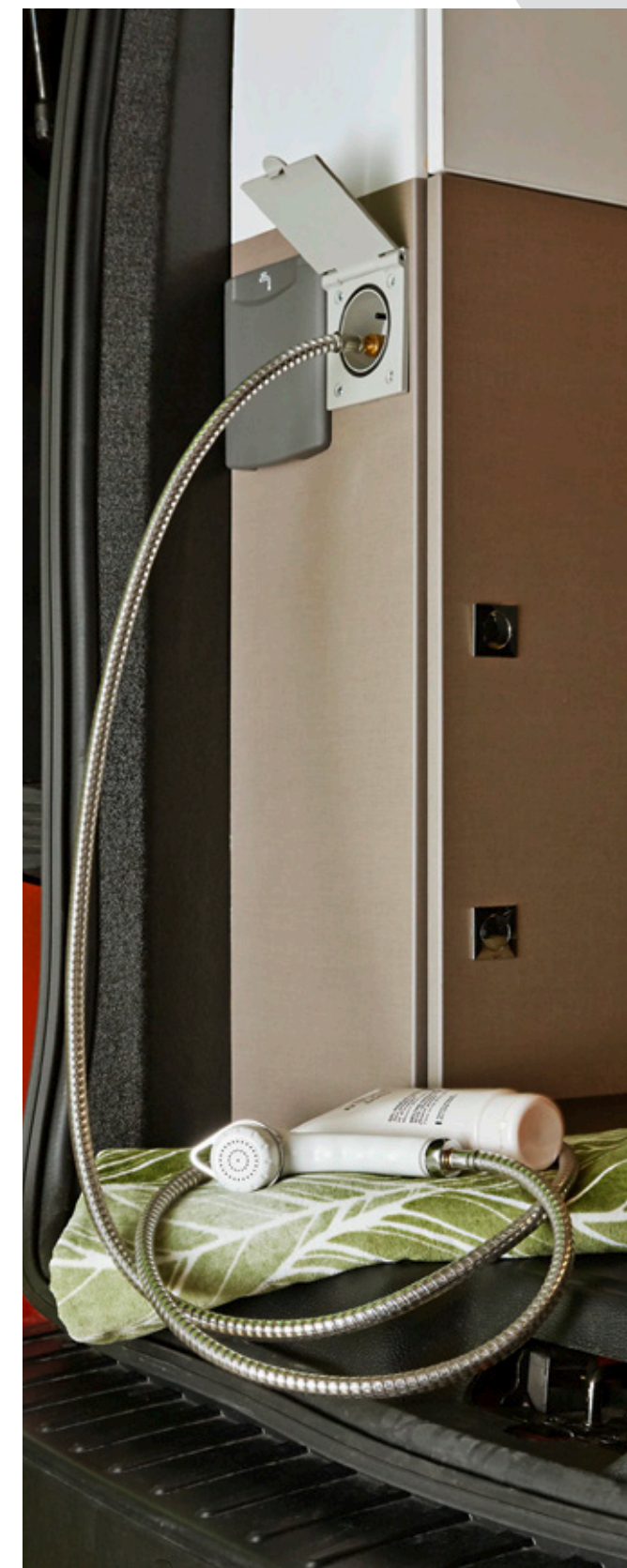
Aansluiting voor de buitendouche (douchekop met slang verkrijgbaar via Bürstner toebehoor 'OTZ').
