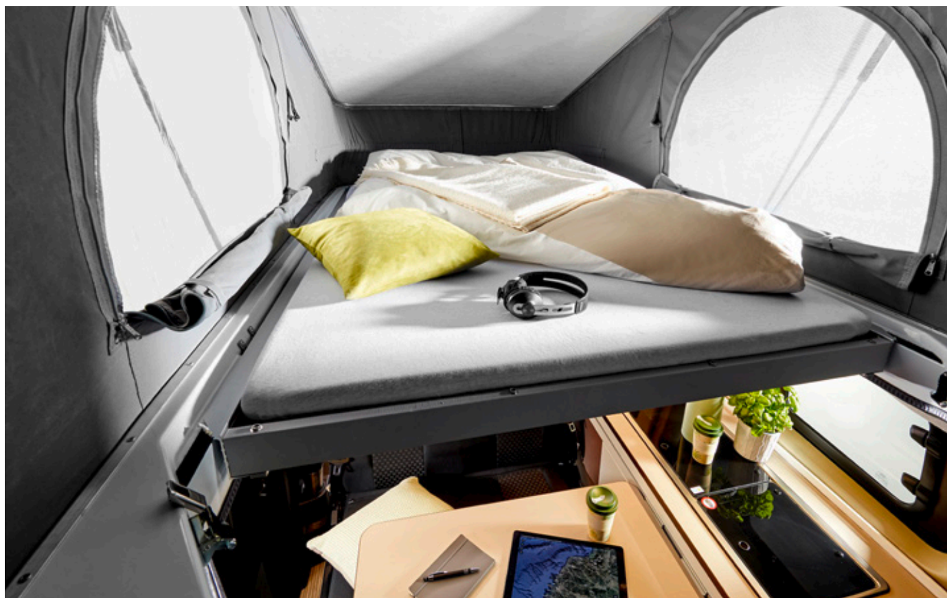
Toit relevable de série avec grand lit double. Les ouvertures et les moustiquaires apportent clarté et protègent contre les insectes.
